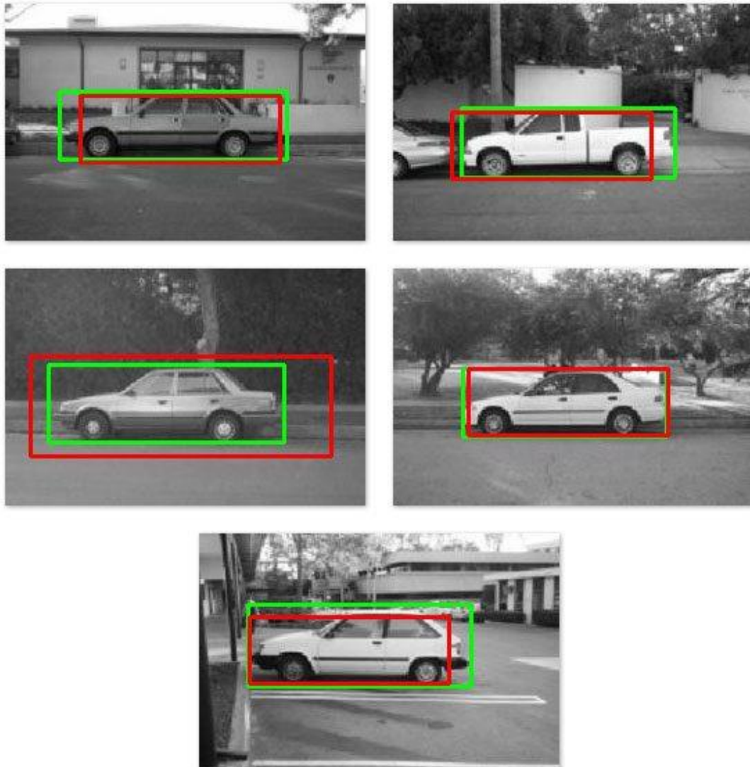
Figura 11.6: Aplicação de IOU para medir a acurácia da detecção de um objeto. Os retângulos vermelhos foram obtidos através de algoritmos detectores, enquanto os verdes correspondem ao espaço real que os automóveis ocupam. Quanto maior for a semelhança entre os dois retângulos, maior será a qualidade da detecção.
