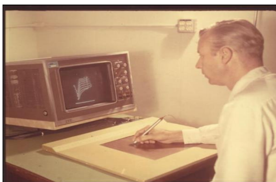
Figura 6.1: Homem inserindo informações no sistema de reconhecimento facial com a utilização de um dispositivo tablet HAND.
